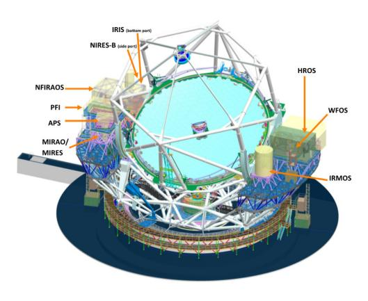
30 m 望遠鏡 三十米望远镜 तीस मीटर दूरबीन Thirty Meter Telescope Télescope de Trente Mètres
